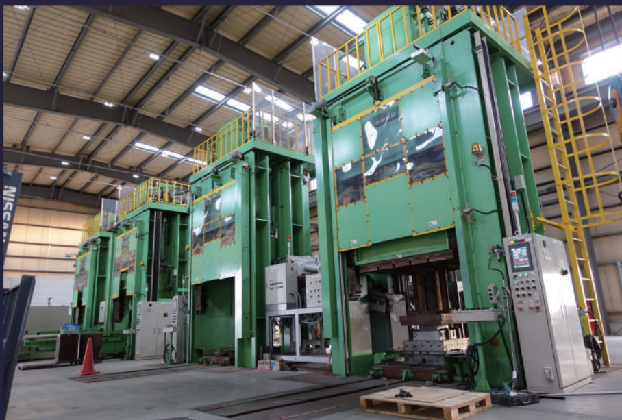
溶湯鍛造技術を支える高圧プレス機 (9基所有)
